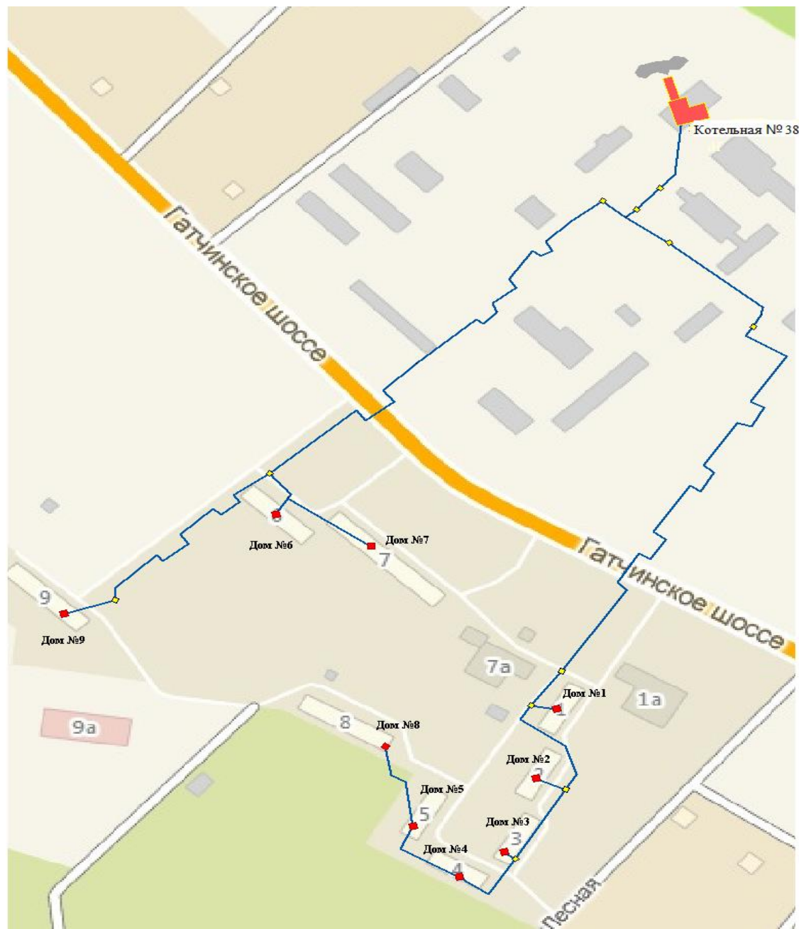
Рисунок 1.12. Схема тепловых сетей котельной №38 дер. Ивановка (контур ГВС)
