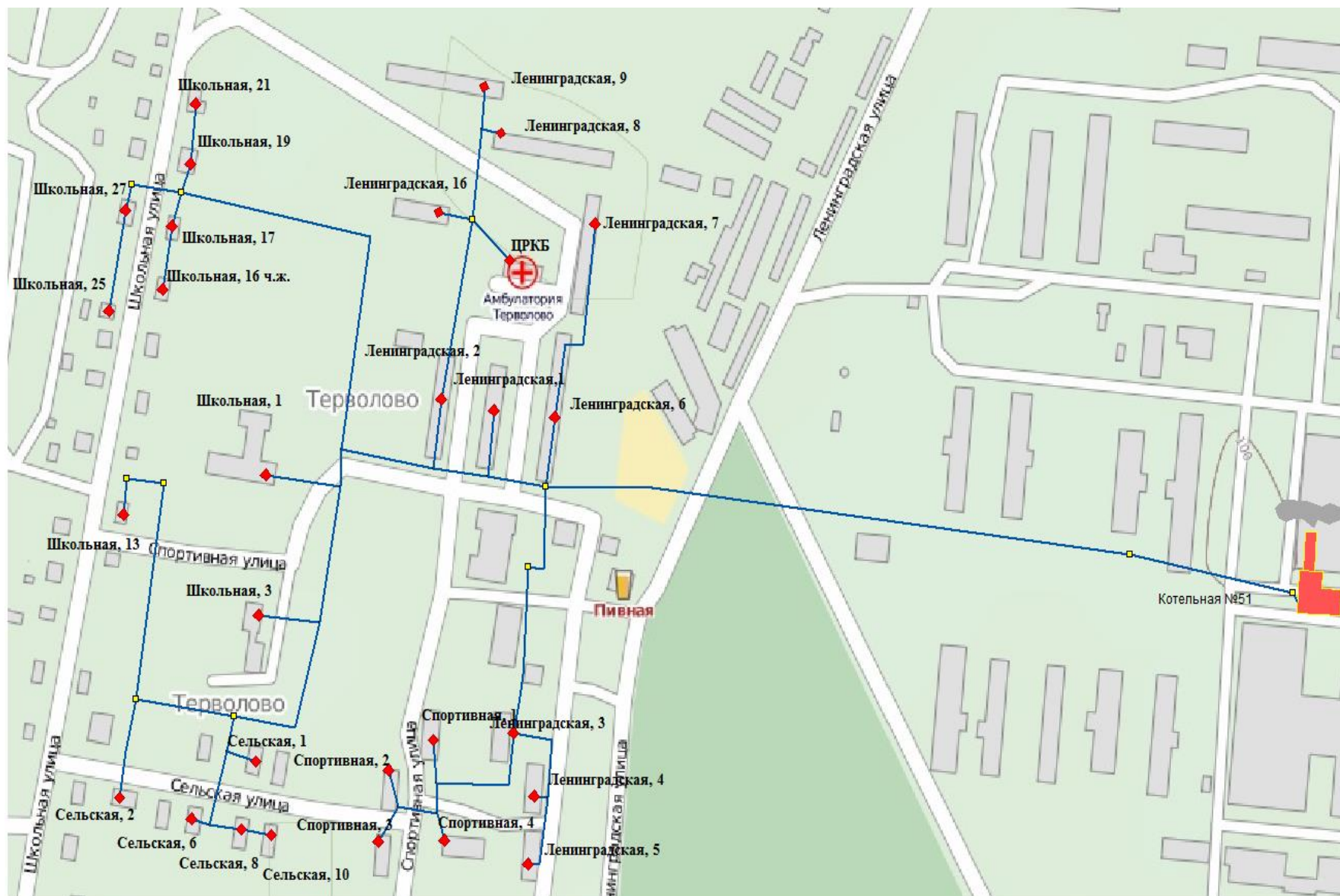
Рисунок 1.9. Схема тепловых сетей котельной №51 пос. Терповолово (контур ГВС)
