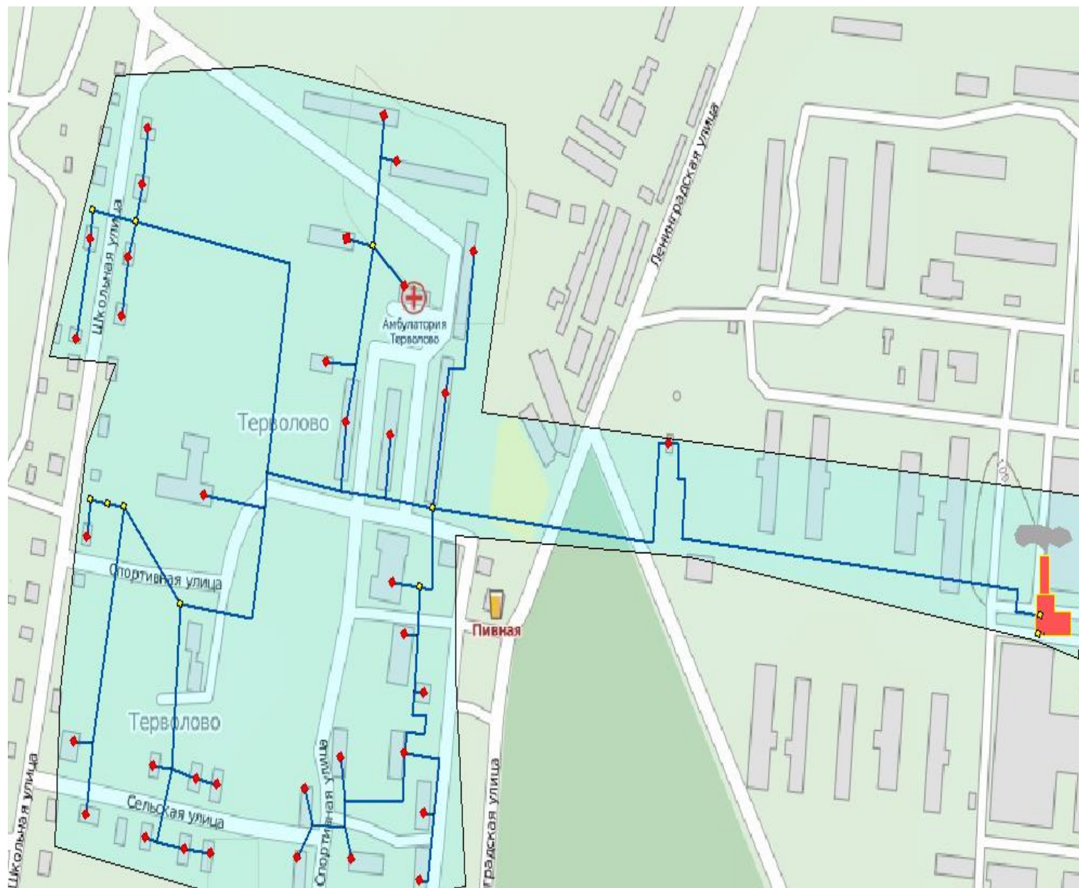
Рисунок 2.2. Зона действия котельной №51 пос. Терволосво
