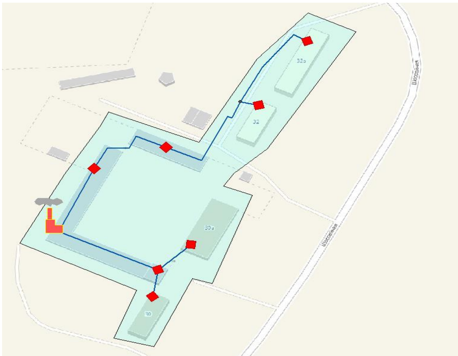
Рисунок 2.5. Зона действия котельной ДРСУ пос. Мыза Ивановка
